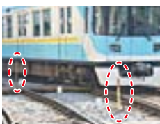
限界支障検知装置
